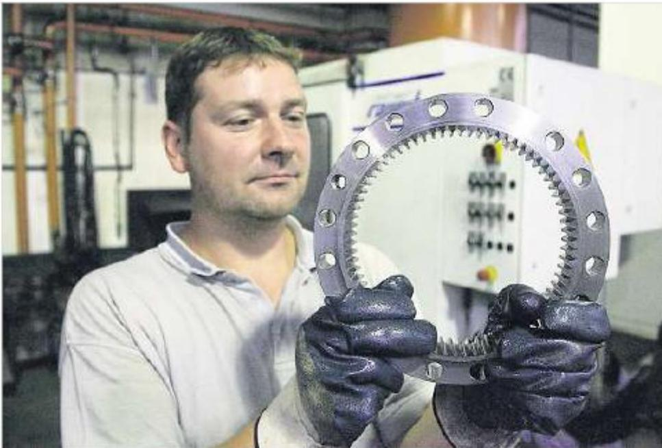
Präzisionsarbeit: Michael Kohlstrunk checkt, ob das Zahnrad fürs Getriebe perfekt ist, vor allem auf eine optimale Härting des Stahls kommt es an, nur so kann das Getriebe einwandfrei funktionieren. Foto: Matthias Schumann
