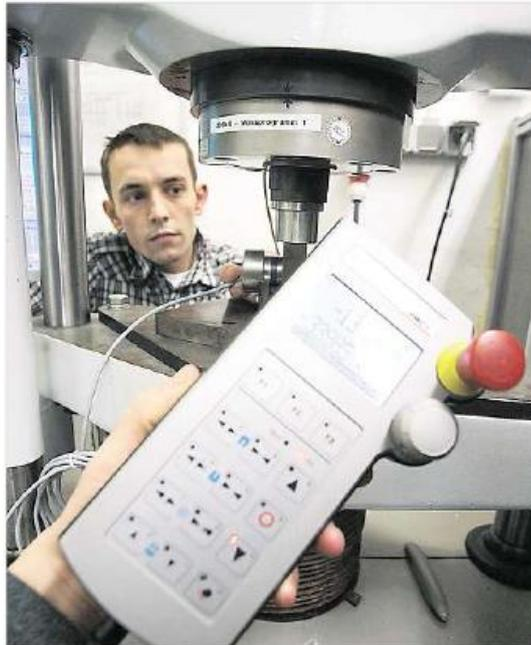
Velomat-Techniker Marc Lehmann arbeitet an einer Prüfmaschine für Kraftsensoren, die zur Überwachung von Kränen nötig sind. Auch in diese Technik wird investiert.
